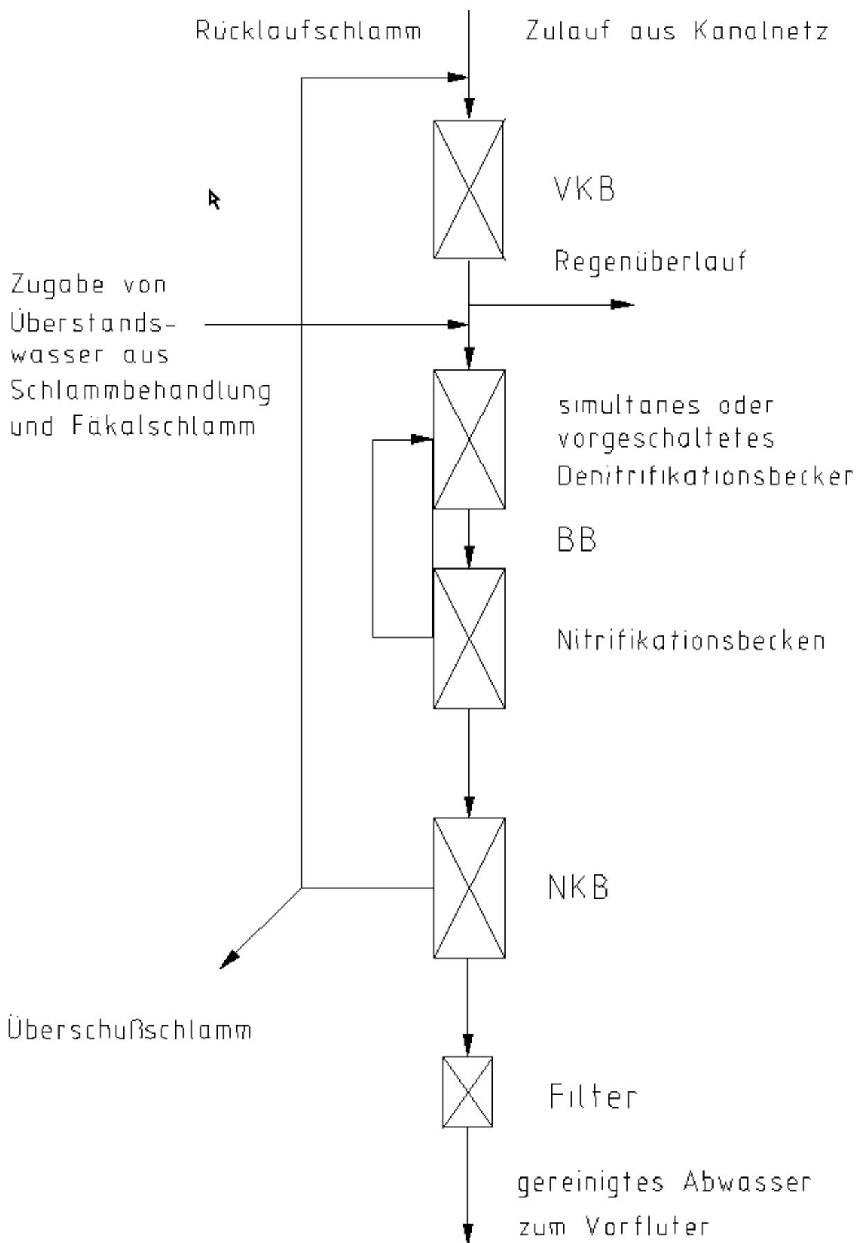
GESIM – Ablaufdiagramm vom Zulauf aus dem Kanalnetz bis zum gereinigten Wasser / Zum Vergrößern anklicken
