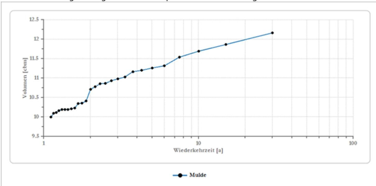
Langzeit: Maximales Füllvolumen einer Regenwasserbehandlungsanlage analog zu DWA-A 117
