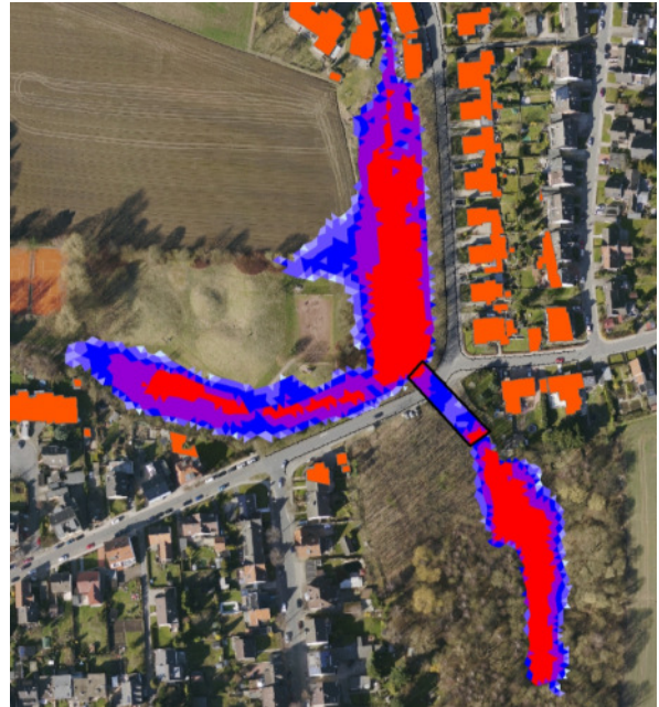
Maximalwasserstände nach Umsetzung von Maßnahmenvariante
